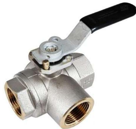
**RuB s.7650L** は、液体の流れの切り替えに最適な選択であり、操作のしやすさと安全性を確保するために、堅牢でメンテナンスフリーのコンポーネントで設計されています。ハンドルを90°回転させるだけで、液体の流れを一方向から他方向に分岐させることができます。従来の手動操作と最新の自動化デバイスを組み合わせています。また、頑丈なレバーハンドルからISO5211アクチュエータフランジアセンブリへの変換も非常に簡単です。低操作トルクと特殊な摩耗低減自己補償バルブシート設計を特徴とし、当社の100,000サイクル寿命試験要件を満たしています。バルブは、ハンドル付き、または**RuB**アクチュエータが既に取り付けられている状態で個別に購入することができます。
