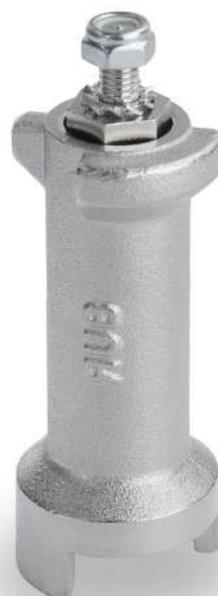
現在、世の中では、将来に向けて資源を維持するために、省エネを意識しています。断熱パイプからの熱損失を防ぐために、**RuB**はステムエクステンションを提供しており、断熱パイプへの断熱性への影響を最小限に抑えながら簡単に作動させることができます。**RuB**ステムエクステンションは、強度の高い熱間鍛造黄銅で、パイプから周囲環境への熱損失が少ないように設計されています。標準的な**RuB**ボールバルブへのステムエクステンションの取り付けは非常に簡単で、バルブを使用している間でも行うことができます。
