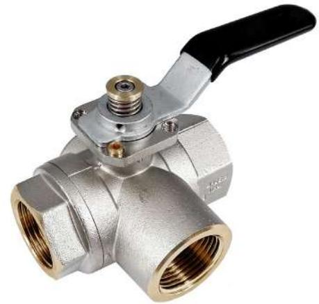
マルチポートバルブであるs.7350シリーズは、省コスト化、および省スペース化を図ります。本製品は、4面シートの採用により全てのポートにボールシートを採用しているため、適用範囲が大きく拡大。どのポートも、遮断可能。ボールポート構成の特定化、および独自のTポート設計によって、流れ方向を自由に選ぶことができます。
