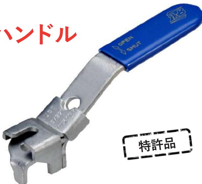
RuBのロック可能なハンドルは、強度の高いGeomet®カーボンスチール製で、不法操作を防ぐように設計されています。RuBのロック装置はバルブの上部ナットをカバーしているため、キーなしでは取り外すことができません。現場でのバルブへの取り付けが簡単なRuBロック可能ハンドルは、OSHA(米国)の安全要件に準拠してs.93バルブでは閉位置でのみロックしますが、他のバルブでは開位置と閉位置の両方でロックできます。
